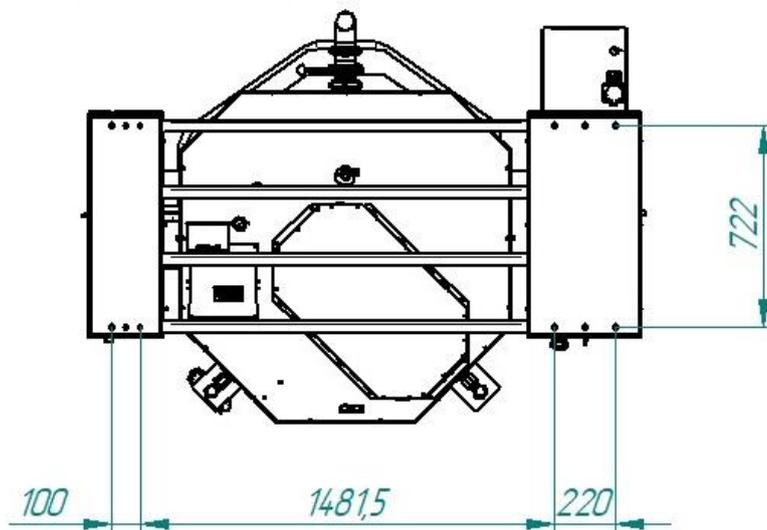
Рис. 5 Размеры для сверления крепежных болтов к полу
