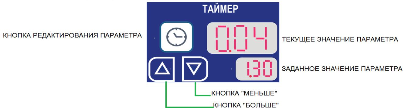
**Индикация параметр «Программа/Мерный залив» и кнопки управления**
